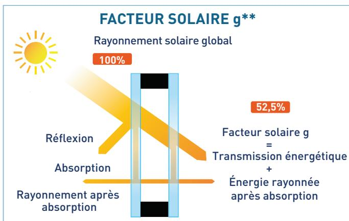
Solitherm Super Eco allie à la fois excellente isolation thermique, haute transmission lumineuse et gain solaire élevé.
